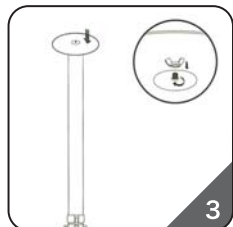
3. ポールの裏のナットをはずしてベースをスクリューに入れて再度ナットで止めて下さい。
