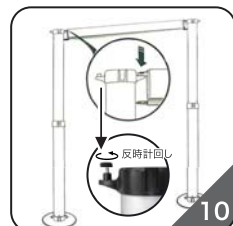
10. ポールの上の左右のフックに掛けて下さい。フックに掛ける前に、左右上部のストッパーねじを外して下さい。
