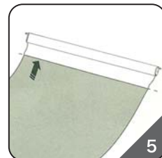
5. 上部のロールユニットにグラフィックを取り付けて下さい。(真っすぐに付けてください。)
