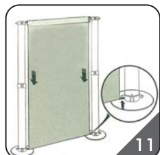
11. 上部からグラフィックをロールダウンさせて下部フックに掛けて下さい。
